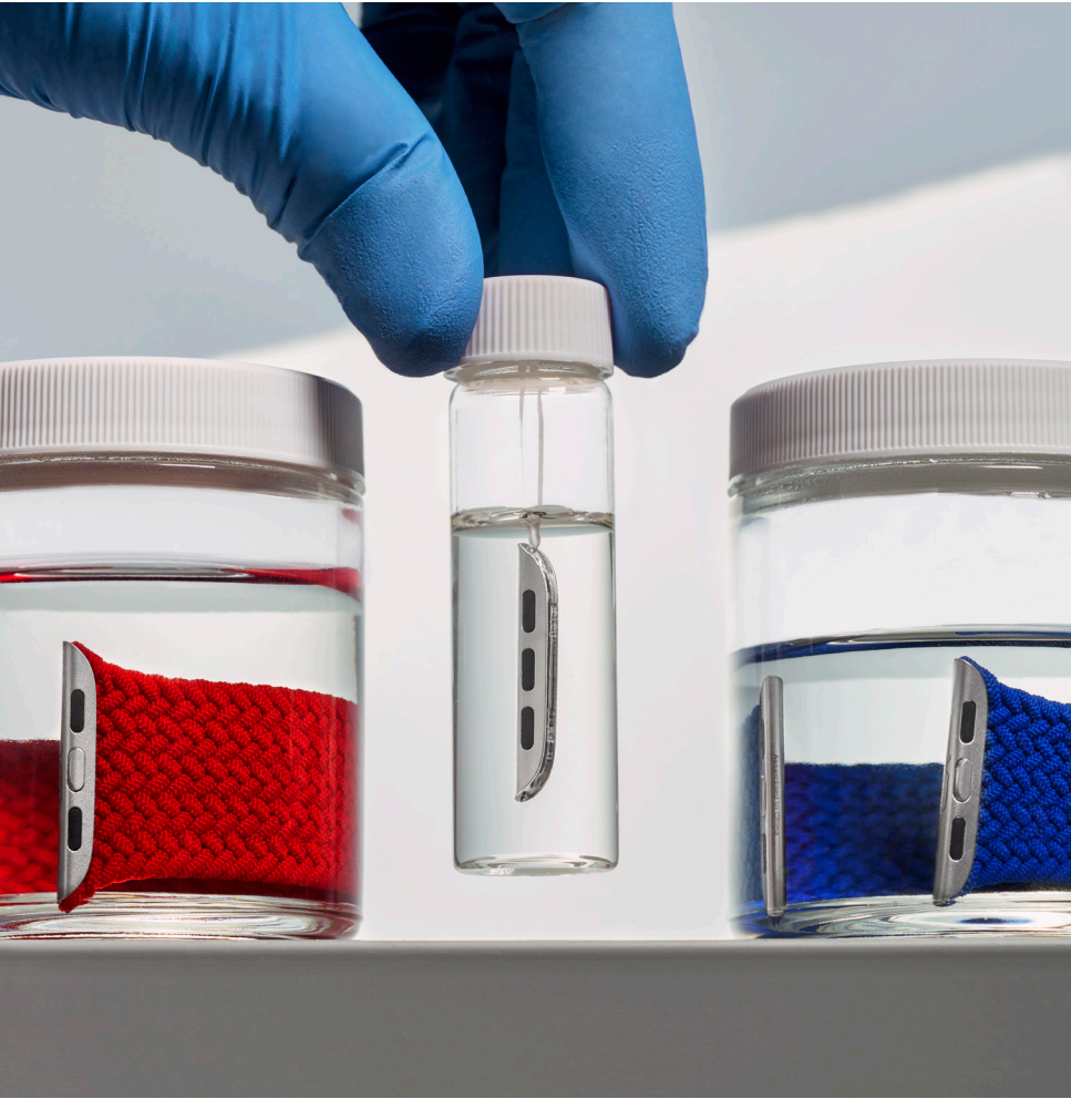
我们对各款产品都进行测试，对长时间与皮肤接触的材料尤为关注。在这项镍沥滤测试中，我们将 Apple Watch 表带放入盛有人造汗液的罐子中，以确保产品中的潜在致敏原镍不会发生转移。
